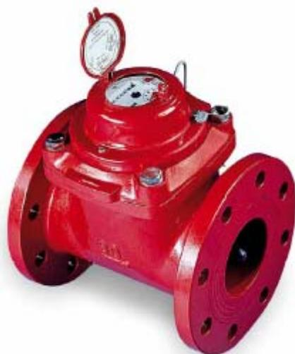
Los contadores tipo Woltman paralelos se utilizan cuando se trata de registrar caudales grandes con un perfil de caudal relativamente constante. Gracias a su diseño robusto no sólo cubren una amplia gama de medición, sino que además proporcionan una precisión de medición estable a largo plazo.
