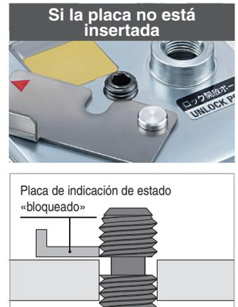
\* Si el perno no se ha girado suficientemente en sentido antihorario, la posición de la ranura no quedará alineada y no se podrá insertar la placa de indicación de estado «bloqueado».
