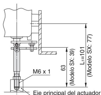
Montaje lateral con palanca horquilla MX
