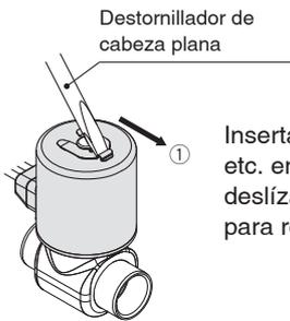
Inserta un destornillador plano, etc. en la ranura del clip y deslízalo en la dirección de ❶ para retirarlo.
