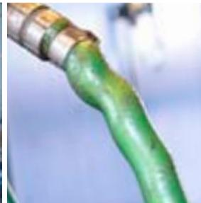
Los acoplamientos antiguos con abrazaderas de manguera provocan fugas y pérdidas de presión
