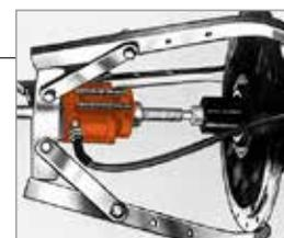
El extractor de 3 mordazas proporciona agarre y sujeción mientras que la bomba manual hidráulica proporciona potencia para empujar el eje fuera de su alojamiento. El protector de eje se usa en el extremo del tornillo extractor.
