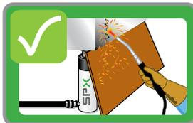
Mantenga el equipo lejos de temperaturas excesivas. No efectúe trabajos de soldadura cerca de equipos sin protección.
