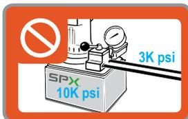
Tenga en cuenta las presiones del sistema. No utilice una bomba de 700 bares en un sistema con componentes para 207 bares (mangueras, herrajes, válvulas, herramientas, etc.).
