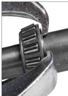
El diseño de mordazas ahusadas permite la fijación alrededor del cojinete para una extracción perfecta.
