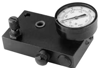
Ofrece lecturas de baja presión más precisas. Retire el bloque del manómetro y el manómetro del comprobador y sustitúyalo con este bloque. Instale el manómetro de alta presión del comprobador (350 bares) en este nuevo bloque.
