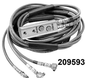
Este control remoto manual tiene dos botones momentáneos, uno para avance y uno para retraer con compensación de resorte para espera. Para usarse con válvulas piloto de aire de 4 vías/2 posiciones.
