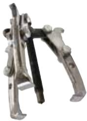
**Extractores con mordazas:** manuales o hidráulicos. Para fuerza extra y mayor comodidad, utilice un extractor hidráulico. Ambos están disponibles en configuraciones de 2 o 3 mordazas y se usan para ejercer fuerza de agarre sobre la circunferencia exterior de una pieza, o pueden utilizarse con un accesorio de extracción, por ejemplo un accesorio para cojinete o polea.
