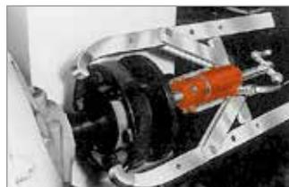
El acoplador flexible se extrae del eje del motor eléctrico con un extractor de 2 mordazas.
