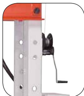
El cabrestante facilita la colocación de la plataforma de la prensa
