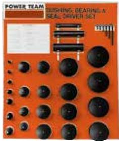
Estos conjuntos incluyen discos y mangos para conjuntos personalizados de instaladores de juntas con el fin de proporcionar una guía (y prevenir la desalineación), un espaciador (para que la fuerza se aplique en los puntos adecuados) y un instalador (para una distribución uniforme de la fuerza). Los discos tienen diámetros que varían entre 12,7 y 114,3 mm, en incrementos de 1,6 mm. Cada juego incluye una caja plástica práctica con bandeja precortada de herramientas.
