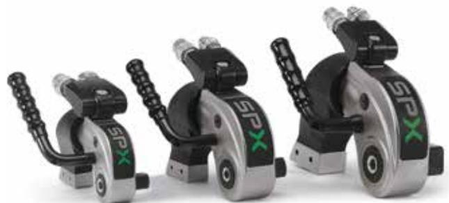
El mecanismo de larga carrera diseñado para la herramienta transmite una rotación de tuerca de 30° como mínimo por carrera, a la vez que mantiene un radio cerrado y compacto en la punta. Esto representa una clara ventaja con respecto a los mecanismos de trinquete de respaldo y corta carrera de los mecanismos de aleación ligera de la competencia. Menos piezas y menos torsión en la operación, lo que trae consigo un menor desgaste y necesidad de mantenimiento, así como menos costes.
