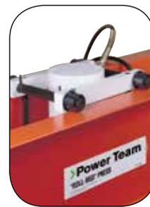
El cilindro se desliza con facilidad por toda la anchura del travesaño superior.
