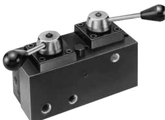
Válvula manual doble de 5 vías, montada en la bomba, 6 posiciones de retención. La presión nominal en la válvula «A» es de 700 bares y en la válvula «B» es de 420 bares. La presión de la caja es de 35 bares como máximo.
