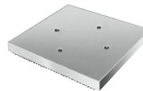
Base de cilindro de aluminio – Para usar cuando es conveniente o necesaria una base de cilindro de mayor tamaño. Se coloca en la parte inferior de los cilindros RA556, RA556L y RA5510 con cuatro tornillos 3/8"-16 (incluidos). Base dentada para una mayor estabilidad.
