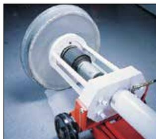
La foto anterior muestra el extractor universal en posición sobre el conjunto de cojinete de rodillos, que está listo para su extracción.
