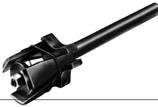
Este instalador se ajusta para adaptarse a las juntas herméticas de los cojinetes de 92 a 165 mm de diámetro exterior. Sustituye más de dos docenas de placas y empujadores. Simplemente ajuste las mordazas para adecuarlas al diámetro interior de la junta, bloquee las mordazas, coloque la nueva junta deslizándola e instálela con un martillo.
