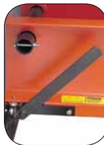
Con la palanca se baja la plataforma para el prensado, se eleva para el laminado.
