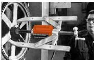
Un extractor de 2 mordazas se puede abrir camino a través de los radios del engranaje para llegar a sujetar el buje. La bomba manual suministra potencia hidráulica.
