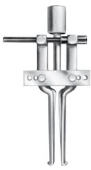
**Los accesorios para extracción interna** tienen mordazas estrechas que se extienden a través del centro de la pieza que se va a extraer. Proporcionan una fuerza de extracción recta y evitan dañar las carcasas. Los accesorios internos incluyen mordazas ajustables que se adaptan a piezas de distintos diámetros.
