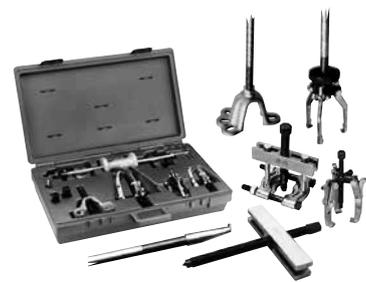
Se pueden instalar componentes para crear extractores versátiles de diversos tipos. El cabezal extractor se gira para bloquear firmemente las mordazas en la pieza que se va a extraer. Se incluye un cabezal extractor de 2 vías y uno de 3 vías, además de tres mordazas de largo alcance y tres de corto alcance en un estuche de plástico. Saca fácilmente engranajes, cojinetes y otras piezas encajadas a presión.
