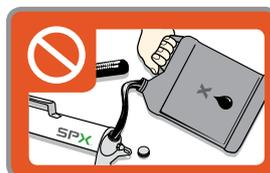
Utilice exclusivamente aceite de alta calidad como, por ejemplo, el aceite hidráulico SPX Power Team. La utilización del fluido incorrecto puede provocar daños en el equipo y fallos prematuros.
